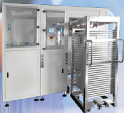
薄板支撐桿式收放板機 (Separator Loader/Unloader)
