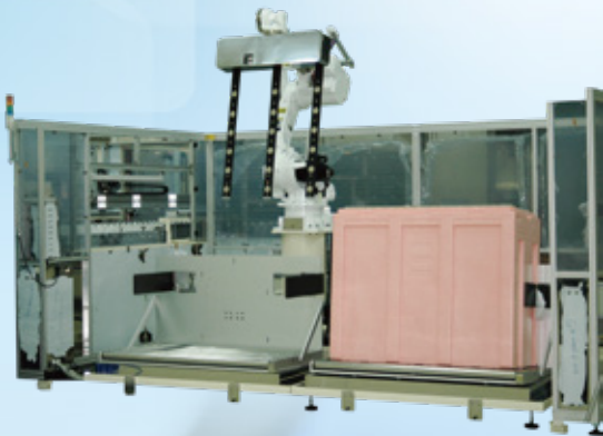
5代PP Box 收/放板機 (G5 PP Box Loader/Unloader)
